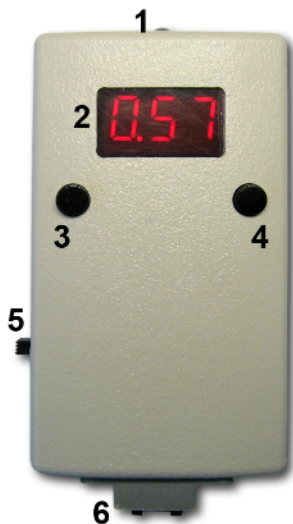
Рисунок 1: Индикатор толщины ИТ-01. Общий вид.
