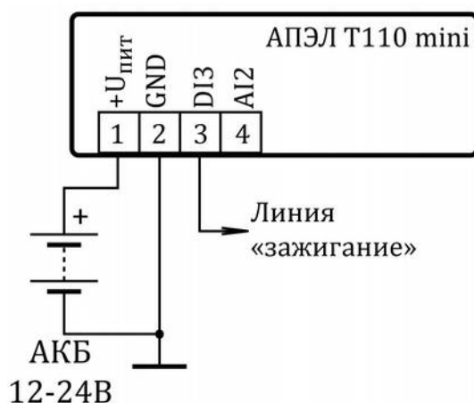
Рисунок 4: Пример подключение зажигания к дискретному входу DI3
