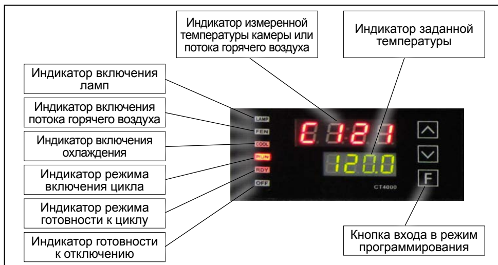
Рисунок 3. Контроллер печи для оплавления паяльной пасты. Лицевая панель
