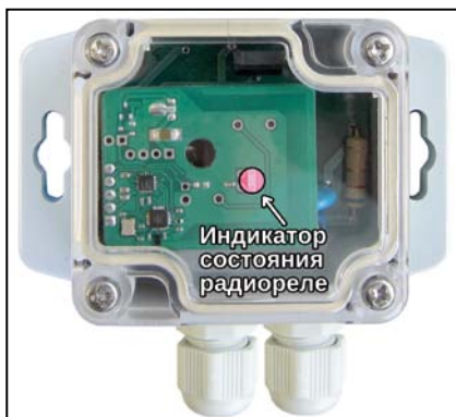
Рисунок 4. Расположение индикатора состояния радиореле.
