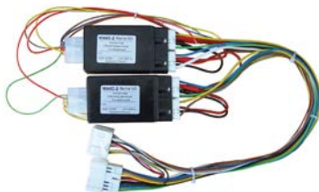
Рисунок 1. Комплект модулей МАКС-2 Vesta NG на 4 двери
