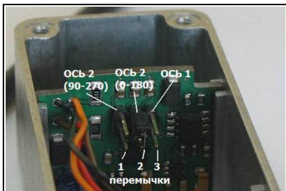
Рисунок 2: Выбор оси измерения
